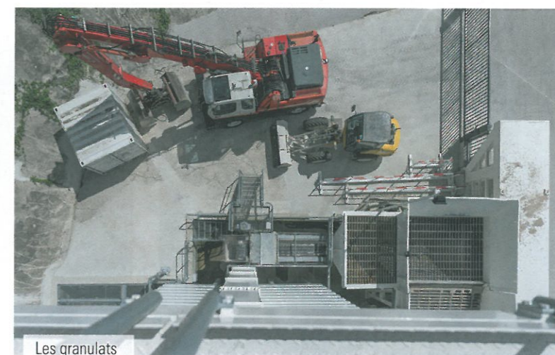
Les granulats sont transférés vers les trémies de stockage par le biais d'un élévateur à godets. A droite, la trémie de déchargement.
